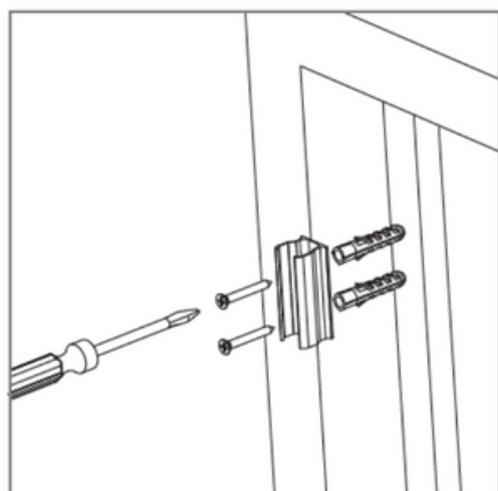
Visser les supports de fixation sur le mur à l'aide du marquage réalisé préalablement et de la visserie adéquate.
