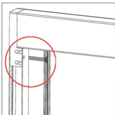
Insérer le coffre dans le haut des coulisses latérales. Les poignées doivent se trouver vers l'intérieur de la pièce.
