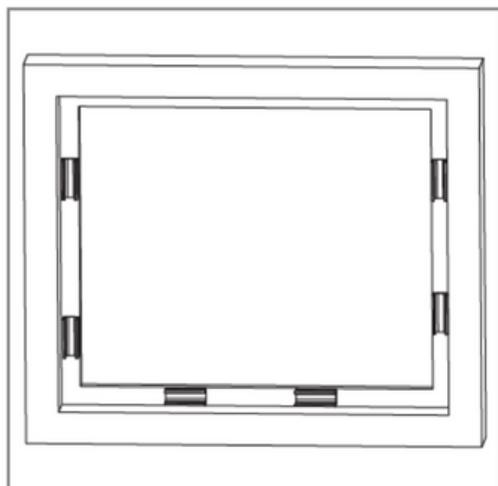
Tracer l'emplacement de perçage de chaque trou de support en utilisant les supports et en les positionnant entre les 2 traits préalablement tracés (attention les supports sont différents les uns des autres).
